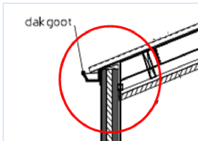
Figuur 1: koudebrug ter hoogte van de aansluiting tussen plafond- en betonpaneel: onderbreking van de isolatie met kans op condensvorming.
